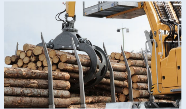
Der LH 60 M Timber ist mit einer Rundholzzange mit 2,8 Quadratmetern ausgestattet.
