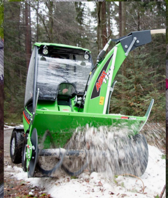
Als Schneefräse, zum Salzstreuen oder für Hubarbeiten: Der Avant 225 hilft bei der Sicherstellung der Verkehrs- und Pfadsicherheit auf und um den Waldwipfelpfad Bayerischer Wald.
