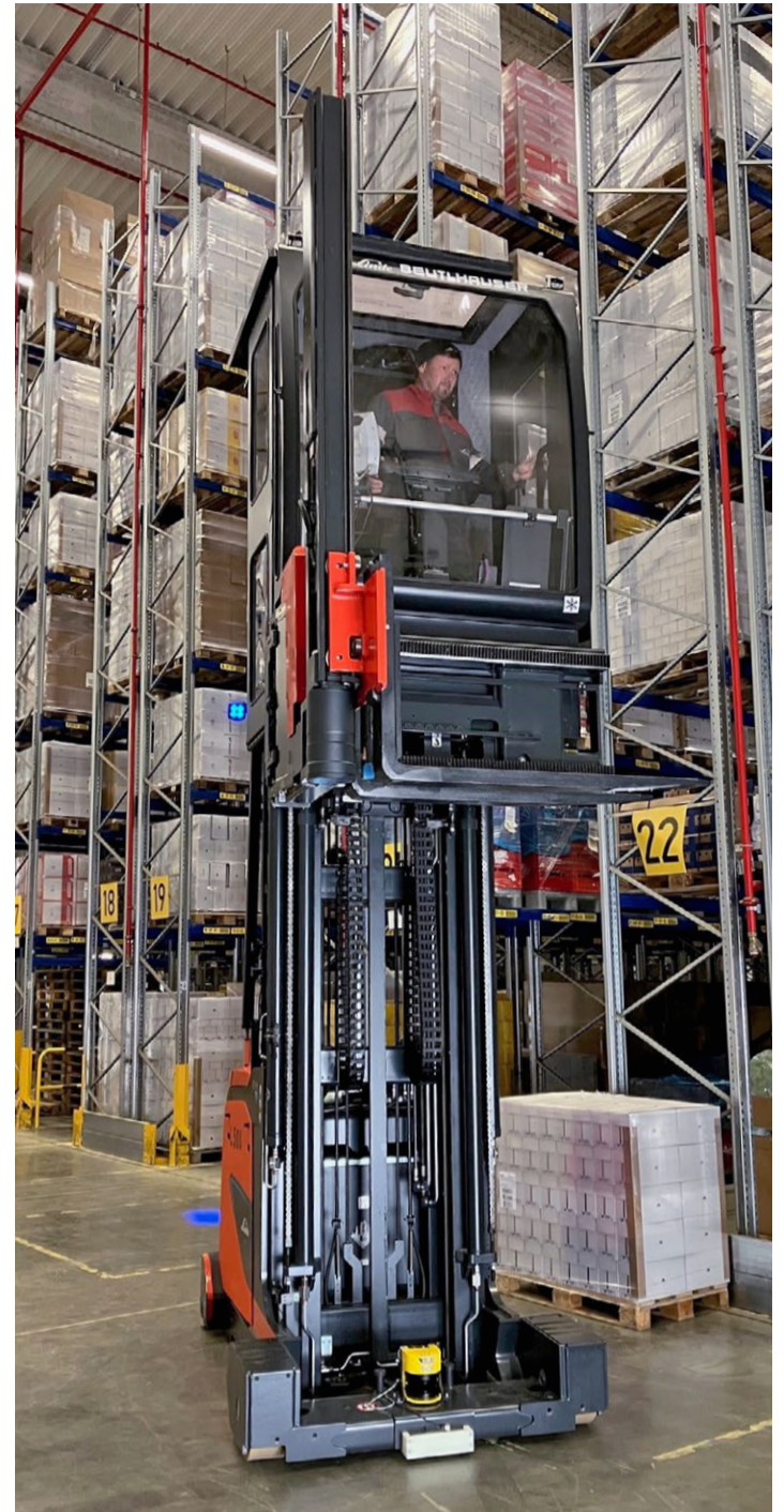
Eine Besonderheit des neuen Schmalgangfahrzeugs bei Heinrichsthaler: Der Fahrer sitzt in einer rundum geschlossenen Kabine, die für die Arbeit im Tiefkühl-Lager konzipiert wurde.
