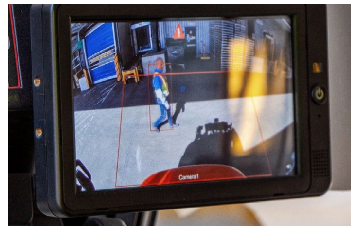
Jürgen Pietsch, Meister im Wareneingang Montage bei ZF Passau, demonstriert die Funktionsweise des neu angeschafften Warnsystems für Stapler. Es warnt einerseits Fußgänger im Gefahrenbereich mittels LED-Blitzlicht (oben) und andererseits den Staplerfahrer visuell und akustisch über einen kleinen Bildschirm (unten).
