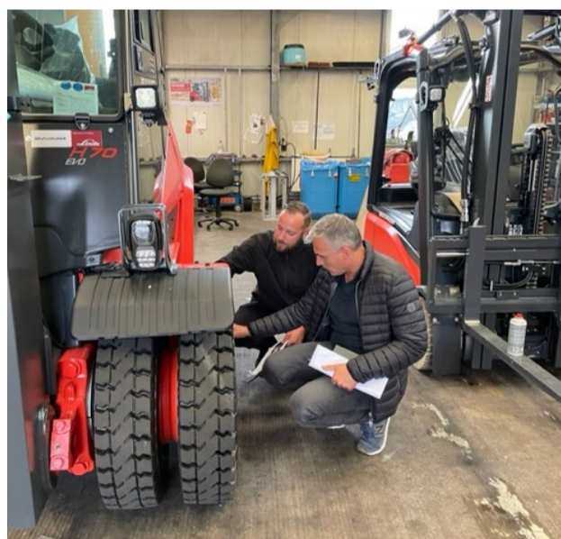
Sebastian Rudow, Einsatzleiter bei Beutlhauser, und Marco Menzel, Leiter Fuhrpark/Logistik bei der Hamburger Rieger, begutachten den Sonderbau Spritzschutz an einem der Fahrzeuge.
