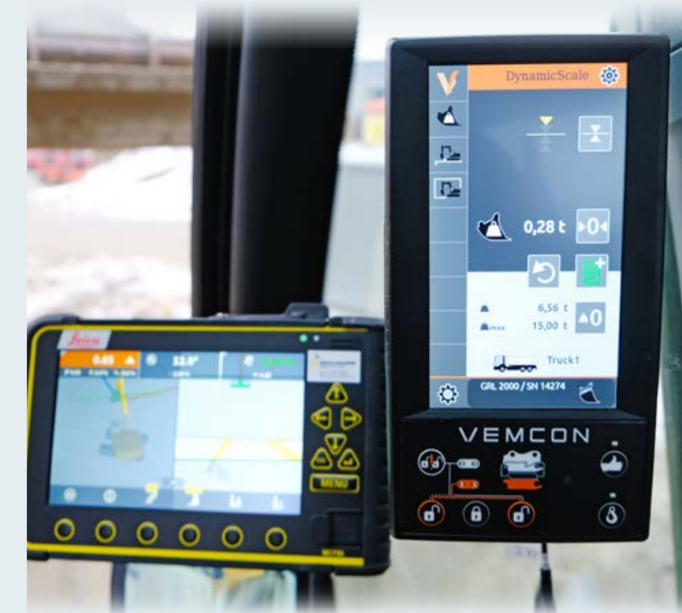
Die dynamische Baggerwaage ermöglicht und vereinfacht das exakte Beladen von Lkws.
