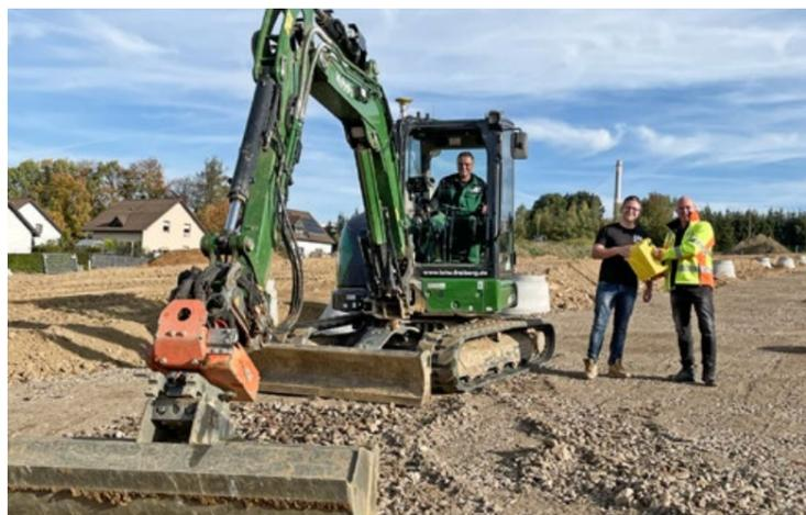
Der Kubota-Kompaktbagger KX060-5 wurde mit einer vollumfänglichen 3D-Maschinensteuerung von Leica Geosystems ausgestattet.
